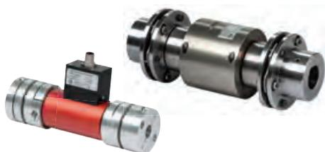
Les servo-accouplements RADEX®-NC et les accouplements à membranes RADEX®-N, rigides en torsion, conviennent pour toutes les séries DATAFLEX® et représentent une solution compacte facilement intégrable. Cependant, l'utilisation d'accouplement sans jeu tel que le ROTEX® GS ou l'intégration de limiteurs de couple reste possible.
