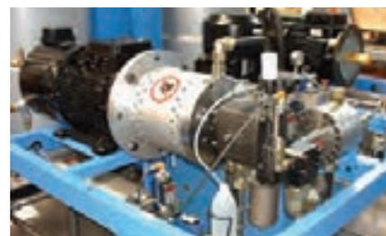
Étanchéité sans entretien de pompes de dosage de polyol et isocyanate pour machines à couler haute pression.
