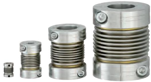
La liaison entre les moyeux alu et le soufflet multi couches est non positive et a fait ses preuves. Le procédé de liaison des tailles 16 à 55 garantit une transmission du couple par chaque couche du soufflet. Le TOOLFLEX®, accouplement à soufflet métallique permet une plage de température jusqu'à 200 °C max. Il est également résistant aux influences de fluides ou conditions de fonctionnement critiques.
